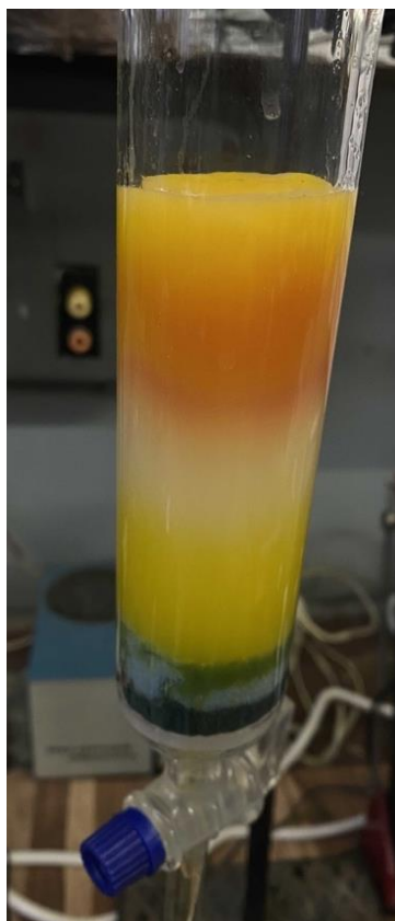
Рисунок 47 – Гель-хроматография меченого FITC белково-пептидного препарата. (разделение фракций свободного FITC и меченого FITC препарата).
