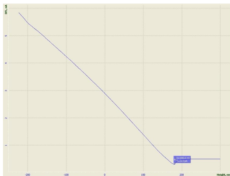
Рисунок 31 – Изменения сигнала DFL, в момент отрыва кантилевера от образца.
