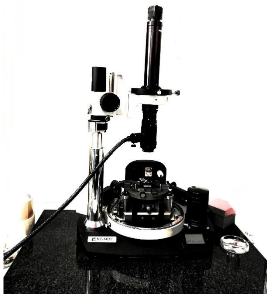
Рисунок 13 – АСМ «NtegraPrima» (NT-MDT, Россия).
