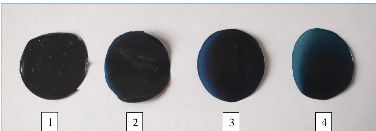
Рисунок 38 – Пленки, полученные из 2 %-го смешанного раствора хитозана и фиброина (1:1), содержащего дженипин при разных соотношениях Gp/NH_2 , моль/моль: 1 - 0,04; 2 - 0,02; 3 - 0,01; 4 - 0,003.
